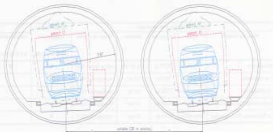
Coupe type d'un tunnel bitube 2 x 43 m 2
