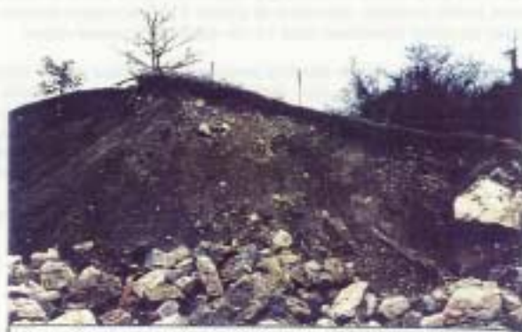
Coupe dans la terre de la coulée de Mont Granier. Blocs très hétérométriques emballés dans une matrice fine.
