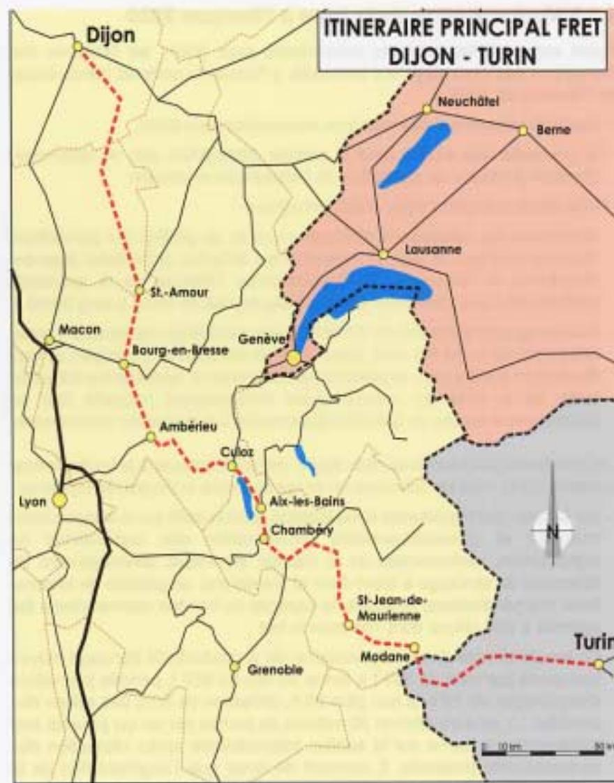
(\*) Gabarit autorisant le transport sur wagons classiques d'une caisse mobile de 3 m de hauteur et 2 m 60 de largeur et permettant ainsi de faire face aux évolutions des dimensions des UTI (unité de transport intermodal).
